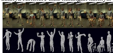
Gambar 2. Hasil depth sensor pada Kinect
